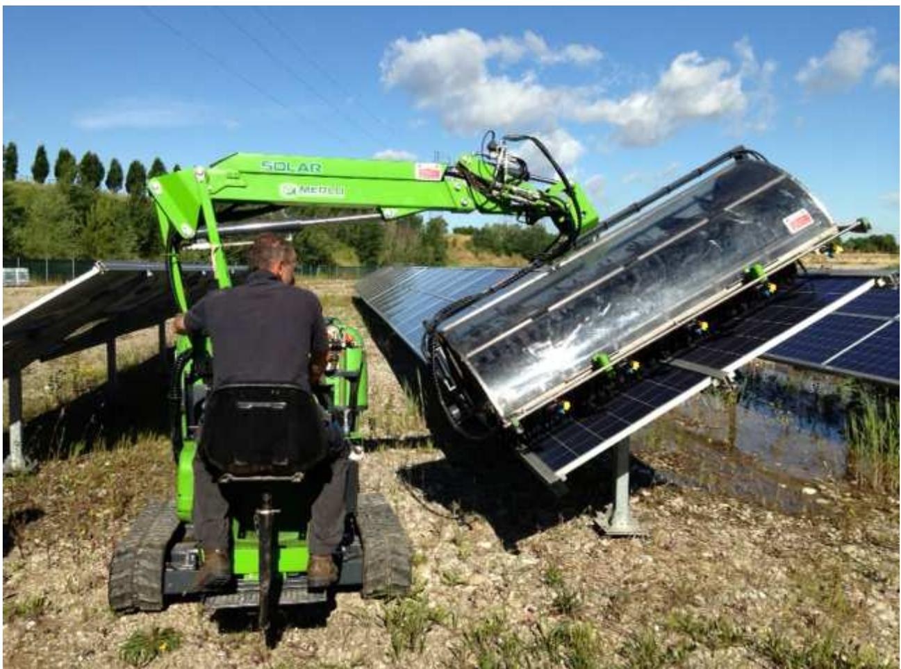
Tutti i sistemi già citati sono completamente integrati in una unità di trasporto mobile che può muoversi su ogni tipo di terreno. Il veicolo è dotato di un deposito di acqua trattata molto capiente.
